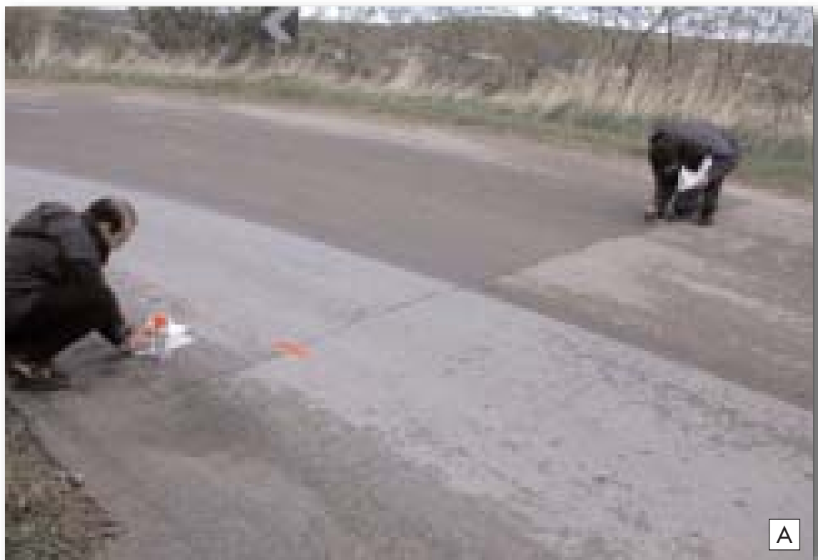
Figura 2.4.10: Due fratture cosismiche che hanno interessato la sede stradale a nord dell'abitato di San Giuliano di Puglia. A) frattura 12 in Tab. II, B) frattura 8 in Tab. II.
