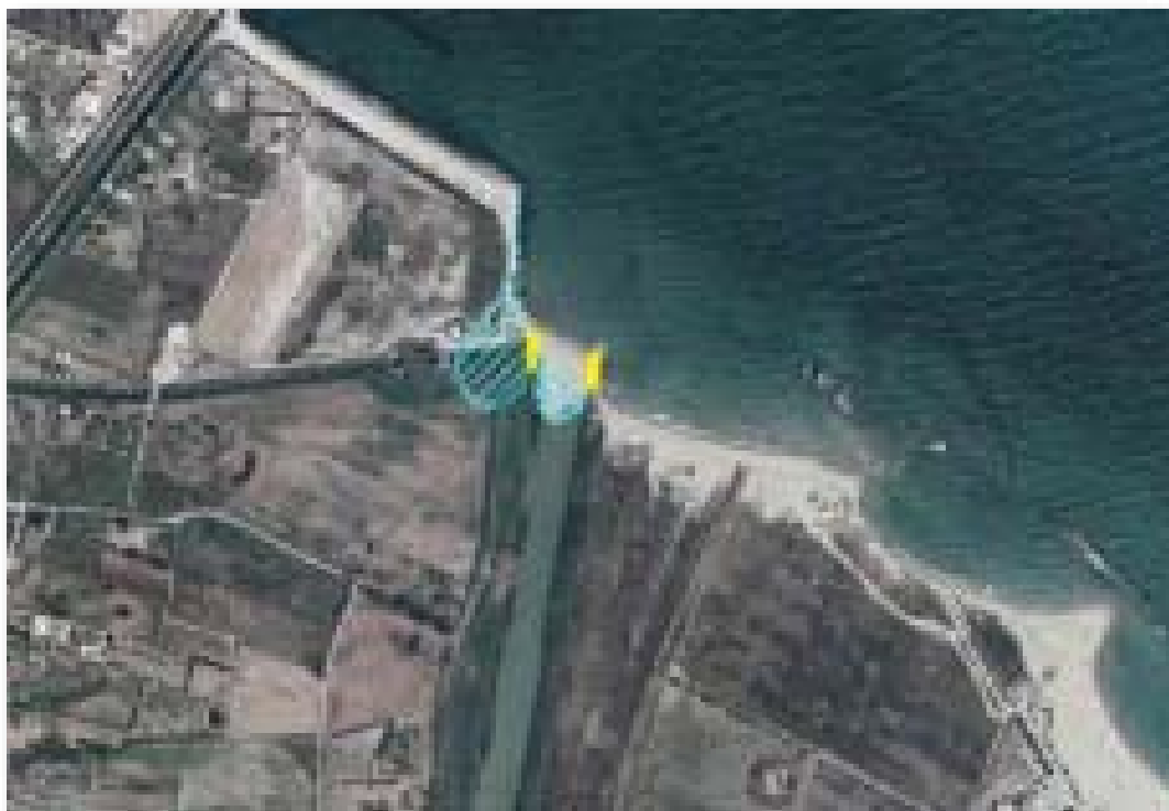
Figura 1.4.33: Ortofotocarta della foce del fiume Biferno; in giallo sono evidenziati i tratti in cui si è verificato il cedimento dell'argine, tratteggiato in azzurro le aree dove gli intensi fenomeni erosivi hanno provocato l'avanzamento del mare.
